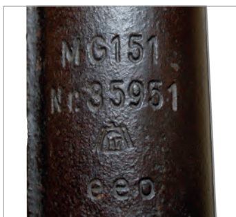
Kulkosvaidžio MG 151/20 spynos dėžutės viršuje (dangtelyje) esantis žymuo. VDKM ginklų rinkiniai, G-1418
