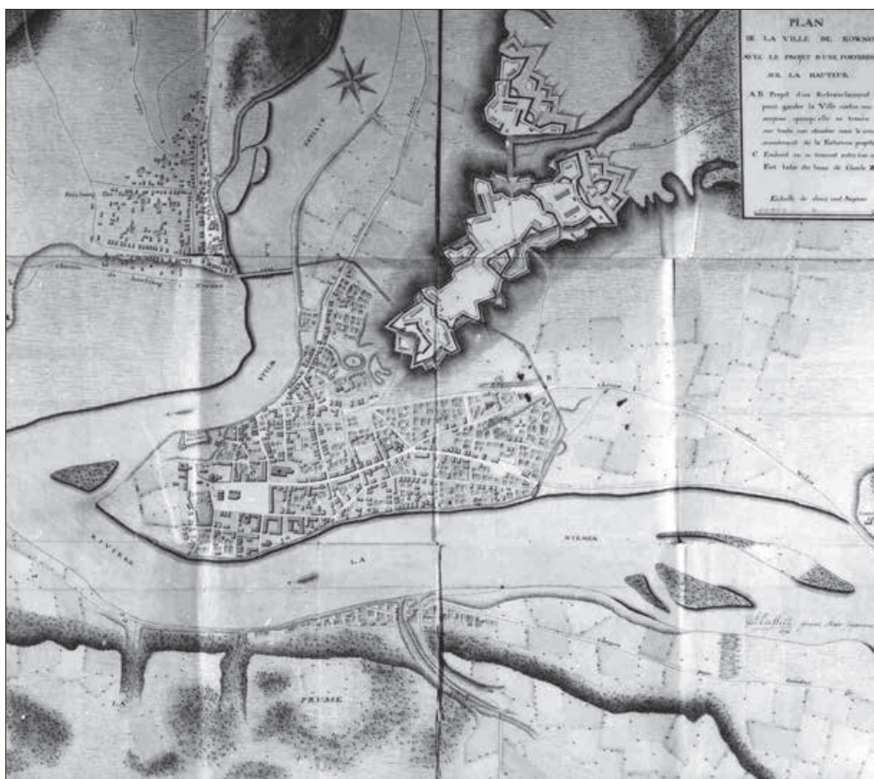
Inžinerijos gen. mjr. J. E. De Vitės bastioninių įtvirtinimų Ažulų kalne planas. 1796 m. VDKM negatyvų rinkiniai
