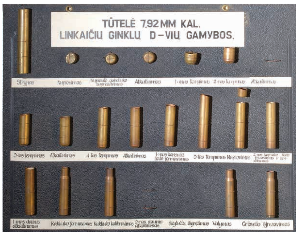
Linkaičių artilerijos dirbtuvių 7,92 mm kalibro šovinio tūtelės gamybos proceso lentelė. 1938 m. VDKM ginklų rinkiniai
