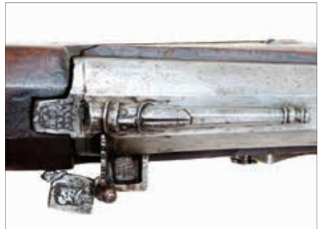
Vamzdelinis taikiklis ir atidaryta parako lentynėlė su dangteliu. Taikiklis dekoruotas kalimo, dangtelis – cheminio išdūrimo būdu
