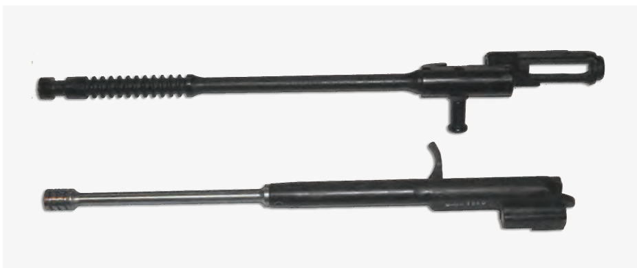
„Sturmgewehr 44“ (viršuje) ir AK 47 stūmoklių palyginimas. < http://www.forgottenweapons.com/ak-and-stg-kissing-cousins/ >, [žiūrėta: 2014 05 08].
