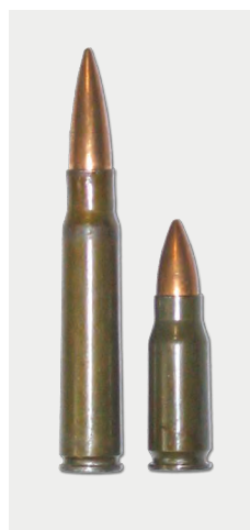
Naujas „Polte“ (sumažintas) 7,92 x 33 mm šovinys lyginant su senuoju 7,92 x 57 mm. German weapons history of the Sturmgewehr, < http://www.mp44.nl/weapons/mp44_history.htm >, [žiūrėta: 2014 11 15]
