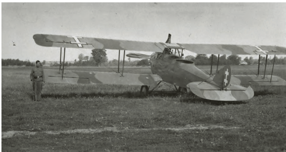
Lietuvos aviacijos žvalgybinis lėktuvas LVG C.VI (Vokietija), dažytas maskuojamosiomis dėmėmis. Kaunas, 1920–1930 m.
