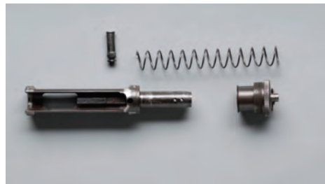
Pistoletas-kulkosvaidžio „L-1“ spynos elementai iš arti. Pagal laikrodžio rodyklę: spyruoklė, drūtgalio dangtelis, spyna, užtaisymo rankena.
