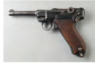
Pusiau automatinis pistoletas „Parabellum“ (Borchard-Luger), modelis P08 (1908 m. modelis), kalibras – 9 mm, Nr. 2968, Vokietija, 1912 m.
