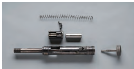
V. Šlechtavičiaus konstrukcijos spynos korpusas ir spynos elementai, Lietuva, 1992. VDKM ginklų rinkinys, G-1758
