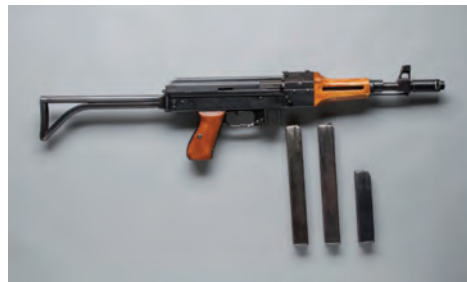
Pistoletas-kulkosvaidis „Vytiš-2“, Lietuva, XX a. paskutinis dešimtmetis. Vaizdas iš dešinės pusės, šalia ginklo – dėtuvių variantai, talpinantys 32 ir 16 šaudmenų.
