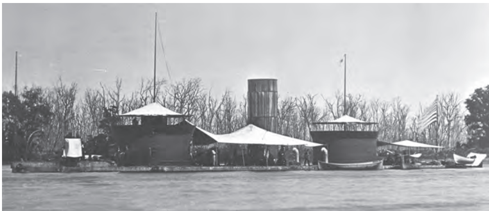
1864 m. Jungtinių Valstijų šarvuotasis upės stebėtojo klasės laivas „USS Onondaga“. Laivas išsiskiria tuo, kad turi ne vieną, o du bokštus.
